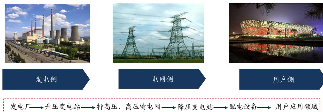
配网，是由架空线路、电缆、杆塔、配电变压器、隔离开关、无功补偿器及一些附属设施等组成的，在电力网中起重要分配电能作用的网络。在城市电网系统中，主网通常是指 110kV 及其以上电压等级的电网，主要起连接区域高压（220kV 及以上）电网的作用，配网是指 35kV 及其以下电压等级的电网，起着向各类用电负荷分配电能的作用。
